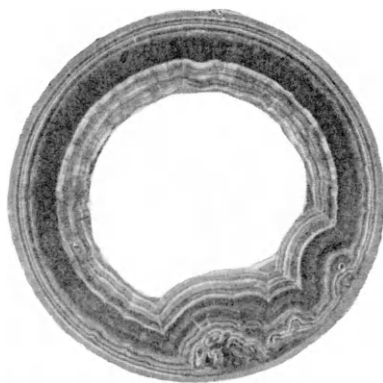
На стенках водопроводной трубы (диам. 15 см) за пять лет осел слой твердого углекислого кальция. Горячий источник Шпрудель (Карловы Вары). Образец Минералогического музея.
