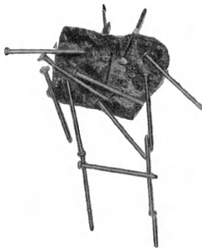
Железная руда — магнитный железнняк горы Магнитной, притягивающий железные гвозди.
